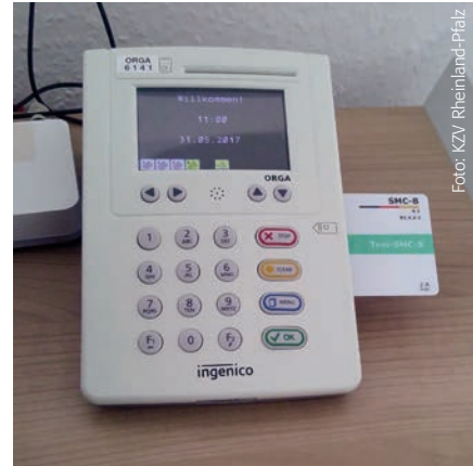
eHealth-Kartenterminal und elektronischer Praxisausweis (SMC-B) sind zwei Komponenten, die Praxen künftig zur Online-Prüfung der Versichertenstammdaten brauchen.
