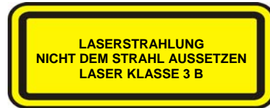
Laser Klasse 3 B sichtbare Laserstrahlung
