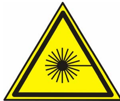
Laser Klasse 3 B sichtbare Laserstrahlung
