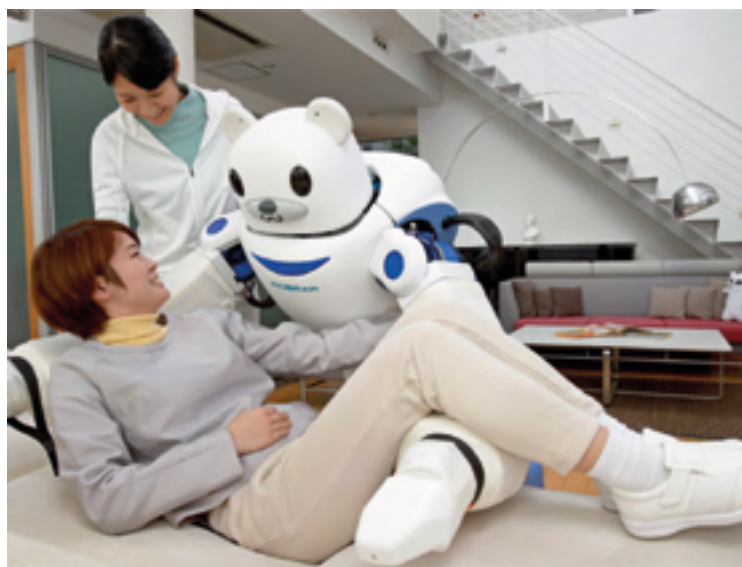
Mit Bärenstärke: Auch „Robear“ wurde in Japan konstruiert und soll gebrechlichen Menschen helfen, aus dem Bett aufzustehen oder auf die Toilette zu gehen.
