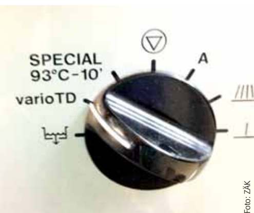
Für Routineanwendungen zum Reinigen und Desinfizieren ist nur das Programm vario TD geeignet.
